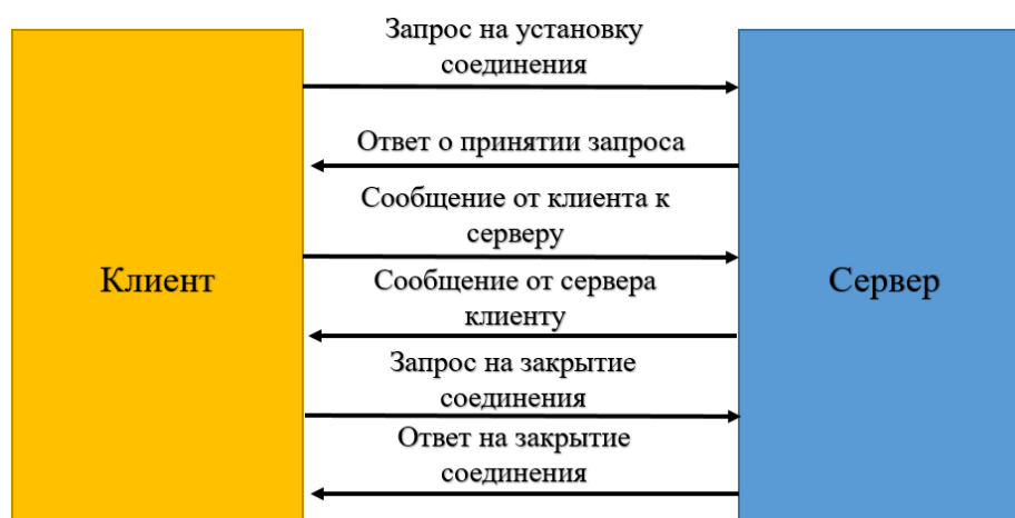
Рисунок 3.5. Коммуникационная модель «Эксклюзивная пара»
